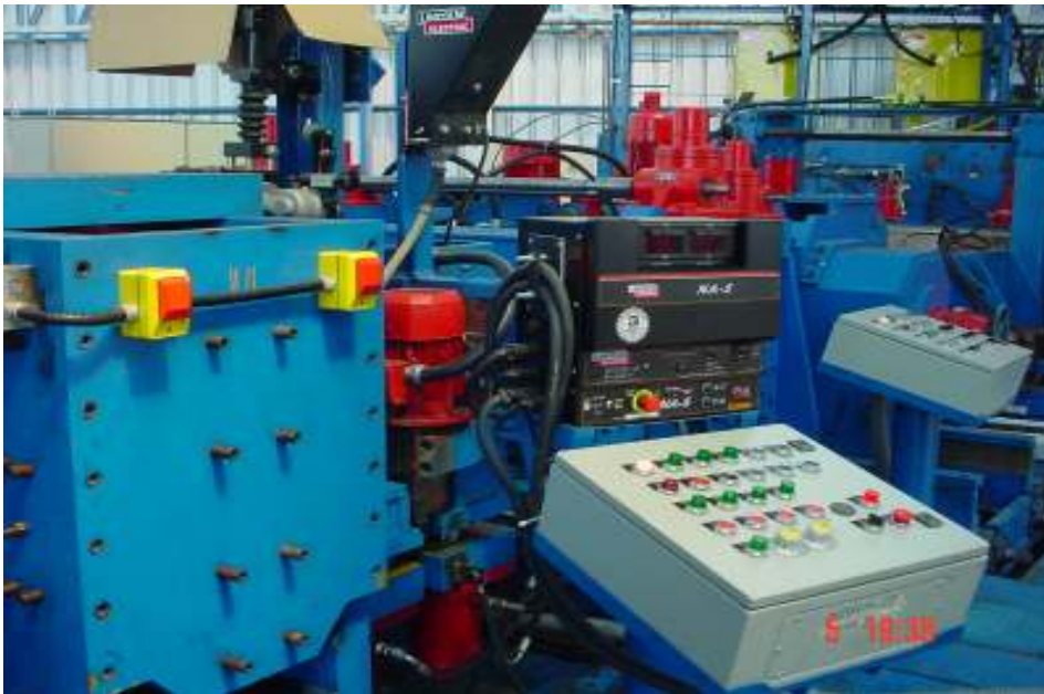
Foto 1 Impianto di formatura e saldatura di tubi
