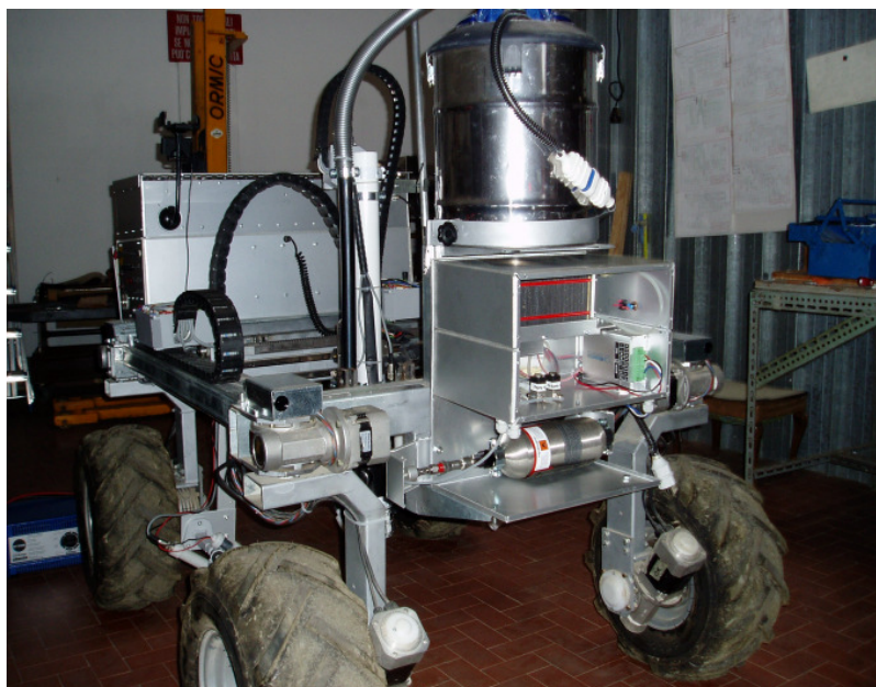
Agri_Robot con propulsore ad Idrogeno,(Fuel-cell) Particolarmente indicato nelle Serre.
